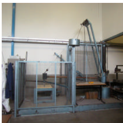
Foto 15 - Prova di perforazione con maglio
