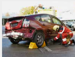
Immobilizzare il veicolo utilizzando le calzaioie.
