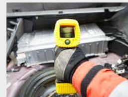
Controllare lo stato meccanico della batteria ad alta tensione e rilevare formazioni di calore con la telecamera termica.
