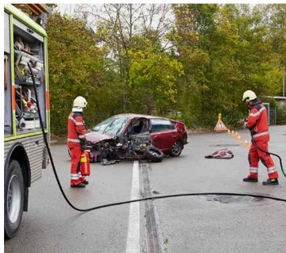
I veicoli incidentati dotati di sistemi ad alta tensione comportano diversi rischi, ad es. archi elettrici, pericolo d'incendio provocato dalla fuoriuscita di liquidi infiammabili e intossicazioni causate dall'inalazione di sostanze tossiche.
