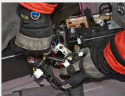
Staccare la batteria 12 V.
