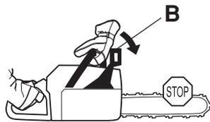
Il movimento attiva un dispositivo a molla che agisce sul nastro del freno (C) spingendolo a bloccare il sistema di trazione della catena (D) ("tamburo della frizione").
