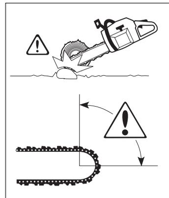
Che la motosega si blocchi nel taglio e la rottura del tronco da tagliare dipendono da due fattori: il sostegno dato al tronco da tagliare durante e dopo il taglio e l'eventuale tensione a cui è sottoposto.
