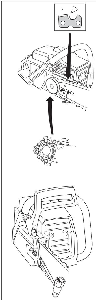
Controllare che il taglio dei denti sia rivolto in avanti, sul lato superiore della lama.
