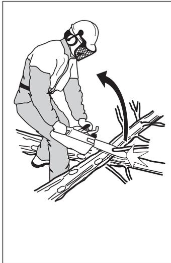
4 Non usare la motosega ad un'altezza superiore alle spalle. Non segare con la punta della lama. **Non usare mai la motosega con una sola mano.**
