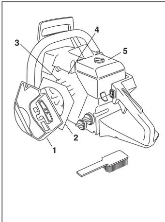
Pulire tutto il sistema di raffreddamento con una spazzola una volta la settimana, più spesso se necessario. **Se il sistema di raffreddamento è sporco o ostruito, provoca il surriscaldamento della motosega ed avaria conseguenti la cilindrata e al pistone.**
