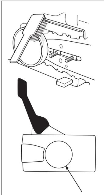
Controllare con regolarità che la fascia frenante abbia almeno uno spessore di 0,60 mm nel punto di maggiore usura.
