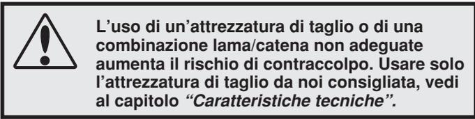
Il contraccolpo si può prevenire olo evitando di toccare un qualsiasi oggetto con la parte superiore della punta della lama, il così detto settore "a rischio". L'adozione di attrezzatura di taglio con riduzione del contraccolpo e mantenendo sempre ben affilata la catena, è possibile ridurre gli effetti del contraccolpo.
