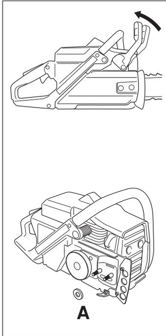
Svitare i dadi della lama, togliendo anche il coperchio della frizione (freno della catena). Eliminare la protezione per il trasporto (A).
