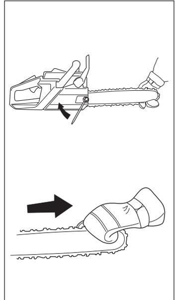
Controllare spesso la tensione di una nuova catena, fino al termine del rodaggio. Una catena correttamente tesa significa migliori caratteristiche di taglio e lunga durata.
