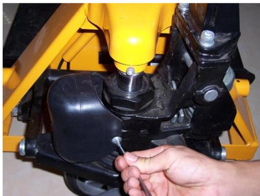
La presenza di aria nell'unità di pompaggio può impedire il sollevamento delle forche. L'aria può essere eliminata posizionando la leva di controllo (H106) in posizione 'abbassata', e quindi muovendo la maniglia (H101) su e giù diverse volte.
