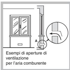
Il sistema può essere realizzato prelevando direttamente l'aria dall'esterno dell'edificio tramite un condotto di almeno 100 cm<sup>2</sup> di sezione utile e tale che non possa essere accidentalmente ostruito.
