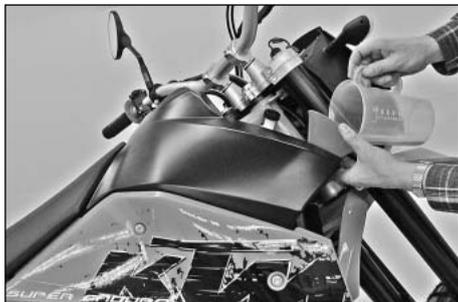
Riempire completamente il radiatore con liquido di raffreddamento. Montare il tappo del radiatore e riportare la moto in posizione orizzontale. Ora riempire il vaso d'espansione con liquido di raffreddamento finché il livello si trova fra le marcature MIN e MAX e chiudere il vaso d'espansione.
