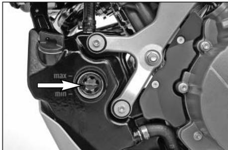
8 **CONTROLLARE IL LIVELLO D'OLIO DEL MOTORE**
