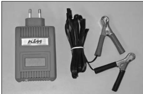
Quando la batteria è scarica, va subito ricaricata. Un prolungato disuso allo stato scarico comporta la scarica completa e la solfatazione delle piastre e di conseguenza la distruzione della batteria.
