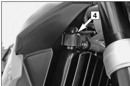
Come liquido di raffreddamento viene impiegata una miscela al 50% di antigelo e 50% di acqua distillata. Il limite della protezione anticon gelamento deve però essere di almeno -25° C. Questa miscela offre oltre alla protezione contro il congelamento anche una buona protezione contro la corrosione e non dovrebbe quindi essere sostituita da acqua pura.
