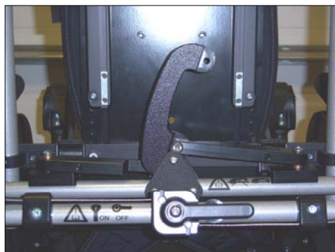
Figura 15: Leva di regolazione angolazione anche in posizione sbloccata
