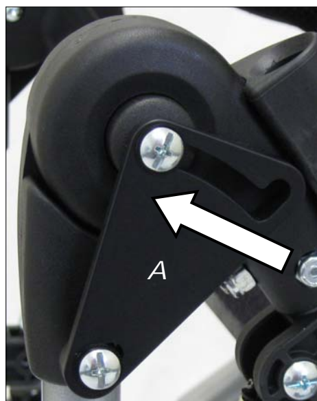
Figura 10: Fare scivolare il triangolo per consentire libertà di movimento
