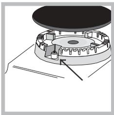
L'apparecchio è dotato di accensione elettronica integrata all'interno della manopola. Per accendere il bruciatore prescelto è sufficiente ruotare la manopola corrispondente in senso antiorario fino al simbolo della
