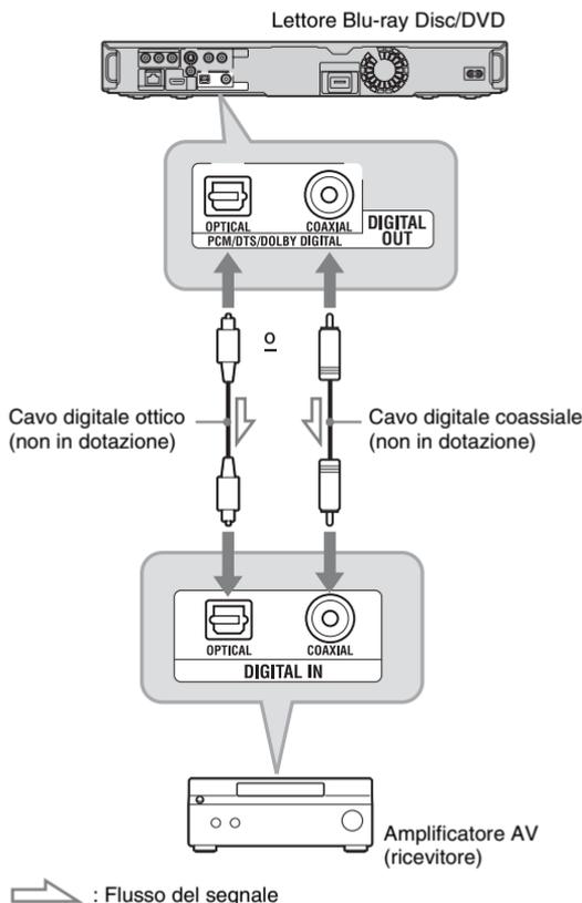
**1** Collegare la presa digitale del lettore e l'amplificatore AV (ricevitore).
