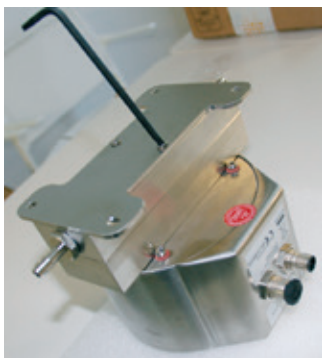
Fig. 4k: fissare la piastra base
