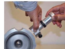
Figura 15: Piedini speciali Portable Rockwell
