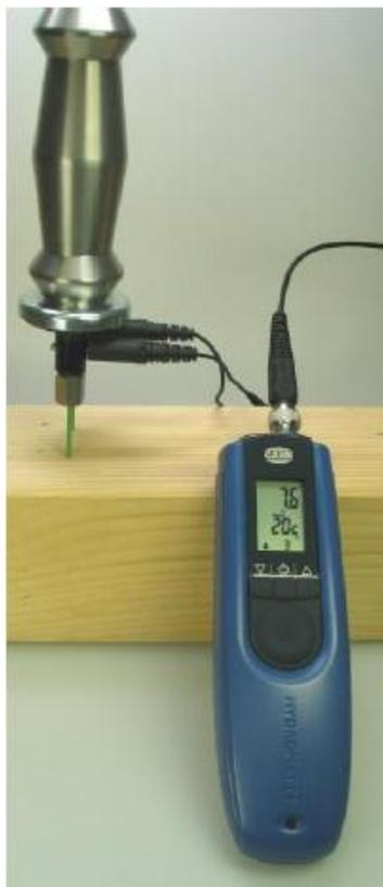
**Fig. 4.2 Elettrodo a massa battente M18**
