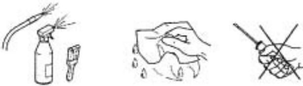
Eseguire la pulizia con acqua e detersivi neutri non abrasivi. Il risciacquo può essere fatto con panno o spugna imbevuti d'acqua, oppure con un moderato getto d'acqua (non superiore alla pressione di rete). Non raschiare le superfici con corpi appuntiti o abrasivi. **NON USARE ABRASIVI O SOLVENTI E DILUENTI.**
