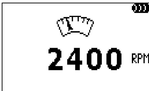
Per una corretta misura è necessario che la velocità dell'albero sia stabile, e letta correttamente dallo strumento. Nel caso questa non sia letta correttamente, sia instabile, oppure inferiore a quella minima, o superiore a quella massima (v. Appendice A), verrà visualizzato uno dei seguenti simboli.:
