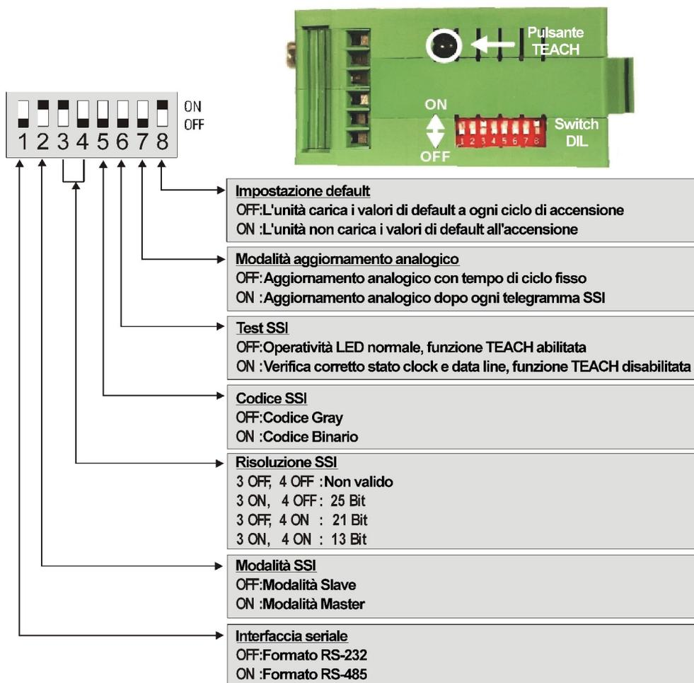
La configurazione degli switch mostrata nella Figura sopra si riferisce a un encoder SSI con risoluzione di 25 bit e uscita in codice Gray, in modalità operativa Master. L'uscita analogica opera con cicli di aggiornamento fissi e la comunicazione seriale è configurata nel formato RS-232.
