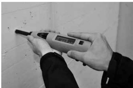
Il numero di impatti di prova necessario per un numero di rimbalzi valido è definito negli standard. Di regola, si tratta almeno di nove impatti. I singoli punti d'impatto devono trovarsi almeno a una distanza di 25 millimetri. Premere lo sclerometro contro la superficie di prova con una velocità ridotta fino a quando scatta.
