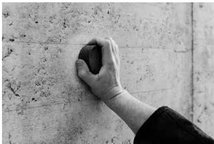
Utilizzare la mola abrasiva per lisciare la superficie di prova. Effettuare alcuni impatti di prova con lo sclerometro su questa superficie piana e dura prima di procedere alle misurazioni da analizzare. Eseguire una verifica della consistenza sull'incudine di prova.
