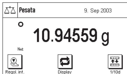
La bilancia è configurata, all'origine, in modo che il risultato della pesata sia visualizzato a grandi caratteri per una facile leggibilità. In questo modo di visualizzazione non sono visibili né i campi informazioni, né la guida grafica per i dosaggi "SmartTrac".
