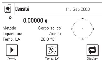
Dopo la scelta dell'applicazione appare quanto indicato a lato. I tasti funzione e i campi informazione relativi alla determinazione della densità sono attivati all'origine. La bilancia è preimpostata per la determinazione della densità di corpi solidi utilizzando acqua come liquido ausiliario. È possibile adattare queste impostazioni alle esigenze personali, seguendo le istruzioni nei prossimi capitoli.
