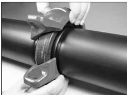
**7. INSTALLARE I GUSCI:** installare i gusci sopra la guarnizione. Assicurarsi che i risalti dei gusci si innestino correttamente nelle scanalature su entrambi i tubi/componenti di raccordo.
