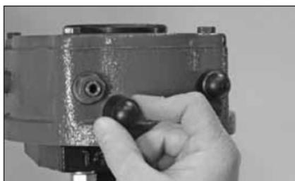
9. Sostituire il coperchio antipolvere di fine corsa.
