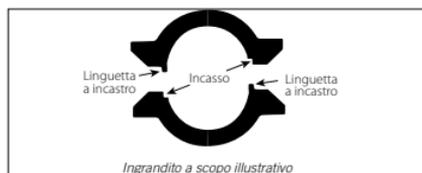
**5. INSTALLARE I GUSCI:** installare i gusci sopra la guarnizione, verificando il corretto posizionamento del meccanismo a incastro. Assicurarsi che i risalti dei gusci s'innestino completamente nelle scanalature su entrambe le estremità dei tubi.
