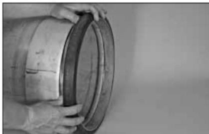
3. **POSIZIONARE LA GUARNIZIONE:** posizionare la guarnizione sull'estremità del tubo o sull'AGS Vic-Ring. Verificare che la guarnizione non sporga sull'estremità del tubo o dall'AGS Vic-Ring.
