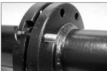
**4a. SOLO PER ADATTATORI DI TIPO 741 E 744:** per facilitare l'installazione sono fornite delle alette di chiusura. Se necessario, utilizzare una chiave inglese per allineare i fori della flangia. In tal modo si faciliterà l'inserimento dei bulloni standard della flangia nei fori di accoppiamento.
