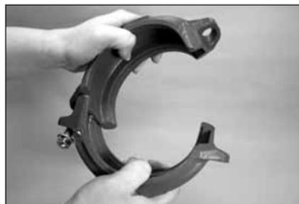
2. **ASSEMBLARE I GUSCI:** inserire un bullone nei gusci e avvitarvi sopra il dado, ma senza serrarlo per consentire la funzione di "oscillazione" mostrata in precedenza. **NOTA:** il dado non deve superare l'allineamento con l'estremità del bullone.
