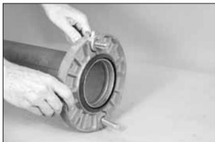
**5b.** Quando i fori per i bulloni sono allineati, inserire un bullone di collegamento standard con diametro a tutto stelo attraverso l'altro foro di accoppiamento dell'adattatore Vic-Flange.
