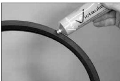
**4. CONTROLLARE LA GUARNIZIONE E LUBRIFICARE:** controllare la guarnizione per accertare che sia adatta alla destinazione d'uso prevista. Il codice colore identifica il grado della guarnizione. Applicare un sottile strato di lubrificante Victaulic o lubrificante a base di silicone sull'esterno e sui bordi della guarnizione.
