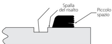
Tubo con scanalature profonde - Figura 1
