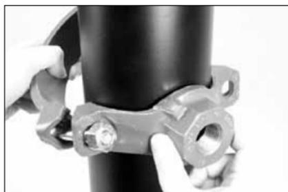
**3. INSTALLARE I GUSCI:** ruotare il guscio inferiore posizionandolo a circa 90° rispetto al guscio superiore (derivazione), come mostrato sopra. Collocare il guscio superiore (derivazione) sulla superficie del tubo, in linea con il foro di derivazione. Ruotare il guscio inferiore attorno al tubo.
