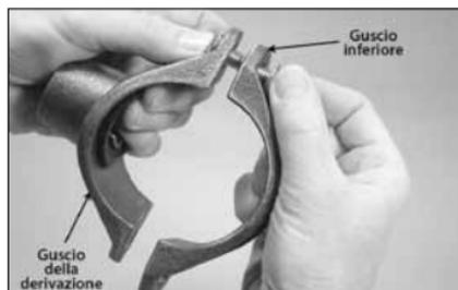
**2. MONTARE I GUSCI:** inserire un bullone nei due gusci. Avvitare un dado flangiato sull'estremità del bullone, ma senza serrarlo (il dado deve essere allineato all'estremità del bullone) per consentire la funzione di "oscillazione".
