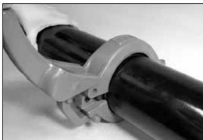
**4. ALLINEARE I FORI:** spingere l'attrezzo di montaggio con decisione fino a unire i gusci e ad allineare i fori per il perno di bloccaggio.
