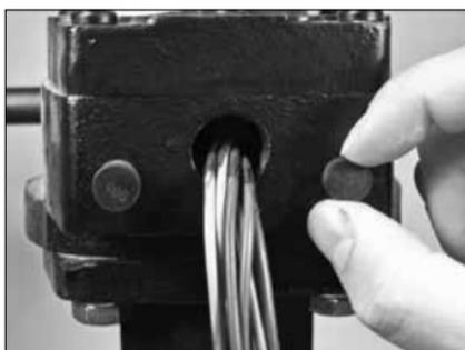
6. Sostituire il coperchio antipolvere di fine corsa.
