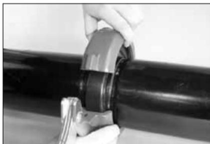
**2. INSTALLARE I GUSCI:** installare un lato del guscio incernierato sulla guarnizione accertandosi che i rialti siano innestati nelle scanalature. Fare scivolare in posizione l'altro lato del guscio. Stringere il guscio per centrare al meglio la guarnizione e posizionare in sede il guscio.
