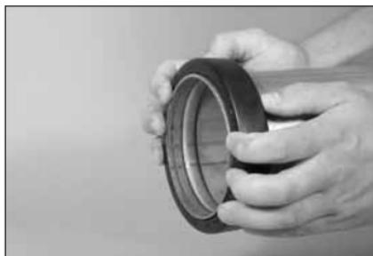
**3. POSIZIONARE LA GUARNIZIONE:** posizionare la guarnizione sull'estremità del tubo. Verificare che la guarnizione non sporga sull'estremità del tubo.
