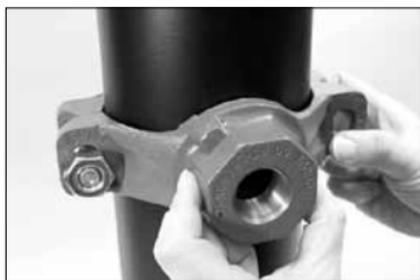
**3a.** Controllare che il collare di posizionamento si innesti correttamente sul foro della derivazione. Verificare l'innesto muovendo il guscio superiore (derivazione) nel foro.
