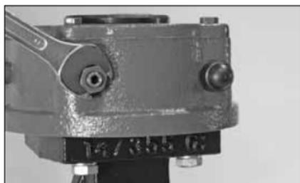
3. Allentare il controdado esagonale (senso antiorario) che si trova sulla sinistra del riduttore a ingranaggi tramite una chiave di dimensioni adeguate.
