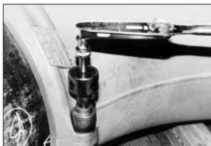
**5. APPLICARE LA COPPIA:** applicare la coppia di serraggio pari a 600 piedi-libbre/ 814 N•m su ogni dado utilizzando una chiave dinamometrica. Poiché sono necessari valori di serraggio elevati, si consiglia l'utilizzo di un moltiplicatore di coppia a ingranaggi.
