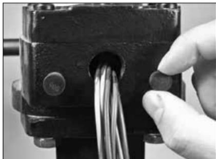
2. Rimuovere il coperchio antipolvere di fine corsa dal lato destro del riduttore a ingranaggi, come illustrato in precedenza.
