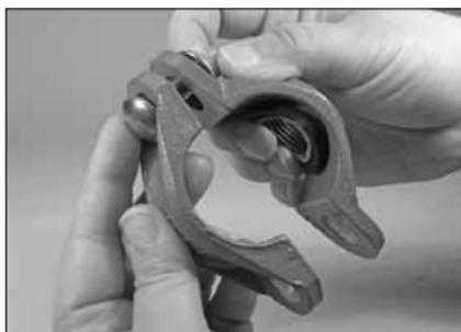
**2. MONTARE I GUSCI:** rimuovere il dado flangiato e il bullone da un solo lato dell'assemblaggio del tipo 912. Avvitare il rimanente dado flangiato sul bullone, ma senza serrarlo (il dado flangiato deve essere allineato all'estremità del bullone) per consentire la funzione di "oscillazione".
