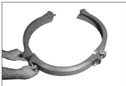
2. **MONTARE I SEGMENTI:** montare i segmenti sciolti (i dadi devono essere allineati con l'estremità del bullone), lasciando fuori un bullone col dado per consentire la funzione di "oscillazione", oppure montare i segmenti sciolti sulle due metà (preferire la soluzione che permette un montaggio più facile).
