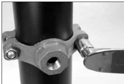
**5. AVVITARE I DADI:** controllare che il collare di posizionamento sia sempre posizionato correttamente nel foro della derivazione. I dadi vanno serrati in modo uniforme, a lati alterni, fino a che il guscio superiore (derivazione) non tocca completamente il tubo.
