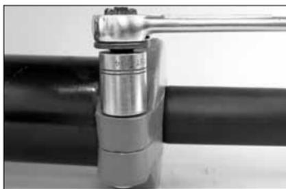
**7. SERRARE I DADI:** serrare i dadi in modo uniforme, a lati alterni, fino a che non vanno in battuta, metallo contro metallo, sulle teste dei bulloni. Verificare che i risalti dei gusci s'insertino perfettamente nelle scanalature.
