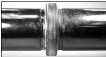
5. **UNIRE IL TUBO/COMPONENTI DI RACCORDO:** allineare le due estremità scanalate del tubo/componenti di raccordo. Inserire nella guarnizione l'altra estremità del tubo/componente di raccordo finché non entra in contatto con il gambo centrale della guarnizione. **NOTA:** assicurarsi che nessuna parte della guarnizione finisca nelle scanalature di entrambi i tubi/ componenti di raccordo.
