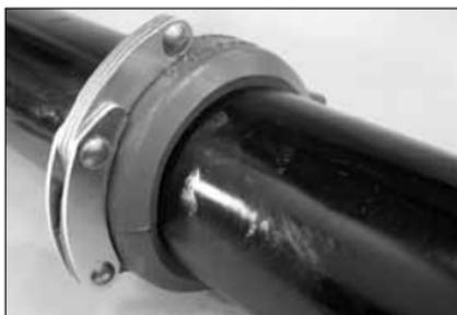
**3a.** Abbassare la maniglia di bloccaggio con decisione fino a toccare completamente il guscio del giunto. Per garantire un corretto bloccaggio del giunto, l'intero corpo della maniglia deve trovarsi in contatto con il guscio del giunto.
