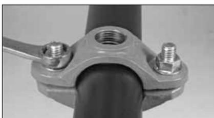
**5. SERRARE I DADI FLANGIATI:** avvitare i dadi flangiati in modo uniforme, applicando un valore di serraggio di circa 20 piedi-libbre/27,1 N•m per assicurare la corretta compressione della guarnizione. **NOTA:** per evitare il serraggio eccessivo dei dadi flangiati, utilizzare una chiave con una lunghezza massima di 8"/200 mm. **NON** serrare eccessivamente i dadi per flangia.
