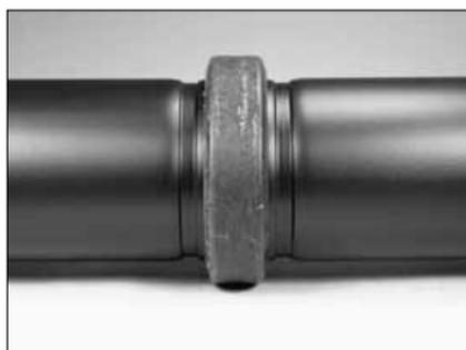
5. **UNIRE IL TUBO/COMPONENTI DI RACCORDO:** allineare le due estremità scanalate del tubo/componenti di raccordo. Inserire nella guarnizione l'altra estremità del tubo/componente di raccordo finché non entra in contatto con il gambo centrale della guarnizione. **NOTA:** assicurarsi che nessuna parte della guarnizione finisca nelle scanalature di entrambi i tubi/ componenti di raccordo.
