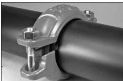
**5. ASSEMBLARE IL GIUNTO:** montare la giunzione inserendo nel giunto l'estremità scanalata di un tubo/componente di raccordo. Le estremità del tubo/componenti di raccordo scanalati devono essere inserite nel giunto finché non toccano lo stelo centrale della guarnizione. È necessaria un'ispezione visiva per garantire che le sedi di accoppiamento siano allineate alle scanalature del tubo/componenti di raccordo.
