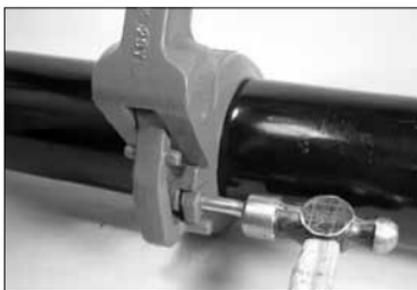
**6. INFILARE IL PERNO DI BLOCCAGGIO:** aiutandosi con un martello, infilare il perno in entrambi i fori nei gusci del giunto, fino a inserire le zone scanalate nel foro.
