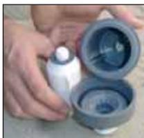
Verificare che il foro di sfiato sia completamente libero. Riasssemblare la valvola facendo attenzione al corretto posizionamento di tutti gli elementi. Pulire la parte filettata 3/4" e riapplicare la valvola al coperchio utilizzando del nastro in teflon.
