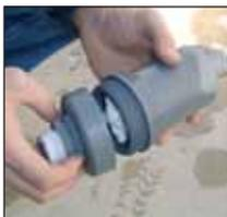
Svitare la valvola dal coperchio del filtro. Aprire la valvola svitando le due parti. Estrarre il galleggiante sfilando la guarnizione dal corpo della valvola. Lavare accuratamente tutti gli elementi con acqua pulita.
