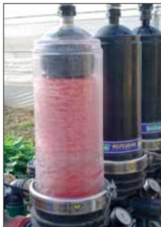
Fig.2 - Fase di controllavaggio
