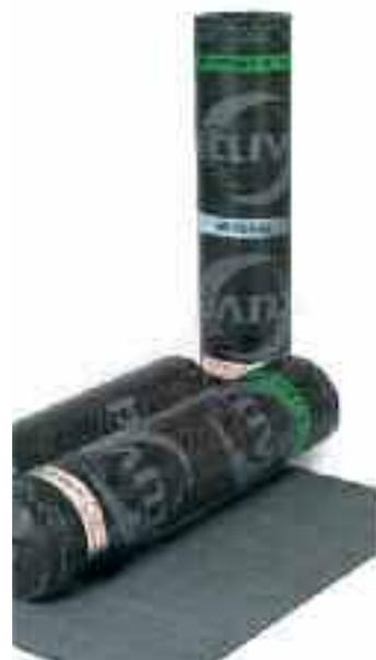
Tenere i rotoli in magazzino, al riparo da raggi solari e ad una temperatura non inferiore a +5°C. Mantenere i rotoli in posizione verticale. Evitare, se possibile, la sovrapposizione dei pallet. Si consiglia di utilizzare il prodotto entro 2/3 mesi dalla consegna.
