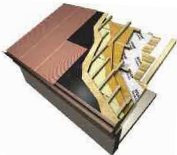
La posa delle membrane dotate di autoprotezione metallica è particolarmente critica e deve essere affidata a maestranze specializzate. Le membrane **BITUVER MEGAVER CU 4,5 Kg TV** sono state sviluppate come secondo strato (a finire) di tenuta e protezione di un sistema impermeabilizzante a doppio strato.
