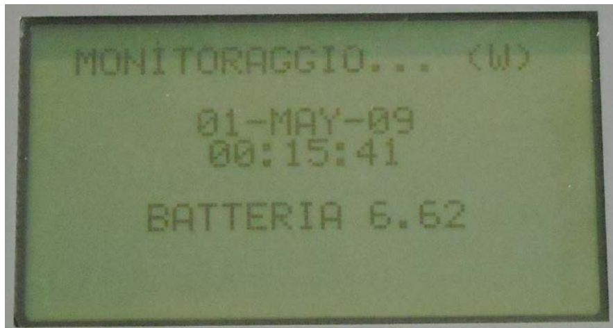
Figura 40: Finestra di monitoraggio, sono fornite le seguenti indicazioni: data, ora tensione della batteria
