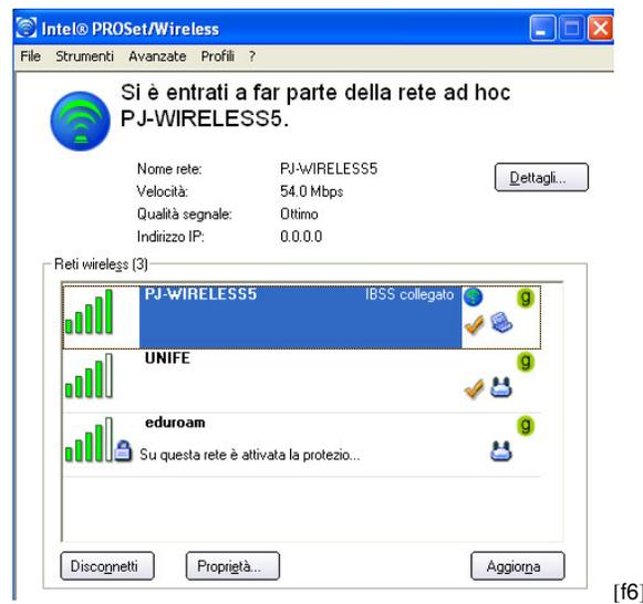
— Collegamento Wireless con il videoproiettore stabilito —
