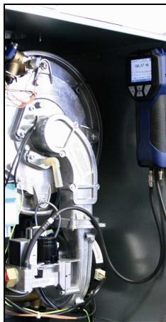
*Imm. 3: Tubo di collegamento del Wöhler DC 420 per la misure perdite UNI 11137-1 metodo indiretto, oppure per la verifica preliminare*
