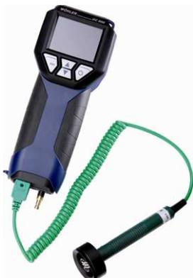
*Imm. 7: Collegamento di una sonda temperatura superficie per il calcolo del valore U dei muri*
