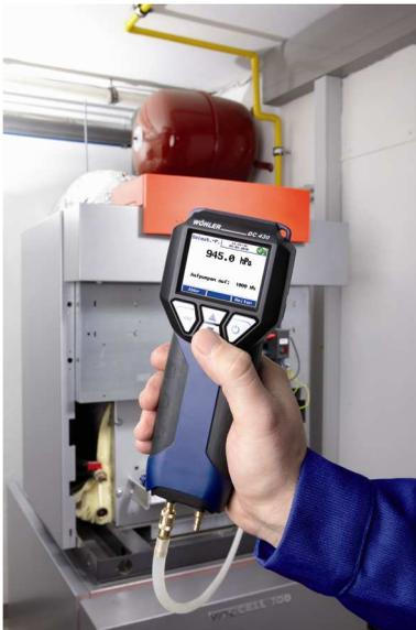
Imm. 31: Prova di tenuta misura diretta con DC 430
