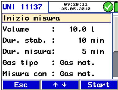
Imm. 32: prima parte del display della prova di tenuta UNI 11137-1
