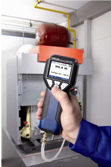
Imm. 25: DC 420 collegato attraverso un tubo direttamente al raccordo tubazione gas
