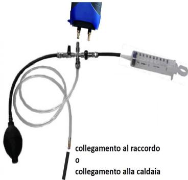
Imm. 20: Collegamento per la prova di pressione
