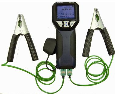
Imm. 6: Collegamento di due sonde di temperatura a pinza
