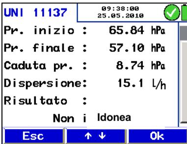
Imm. 37: Il risultato della prova di tenuta metodo indiretto
