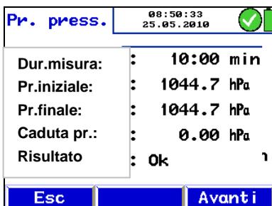
Imm. 24: Risultato della prova di pressione
