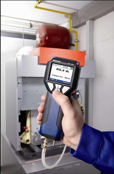
Imm. 2: tubo di collegamento del Wöhler DC 43 per la prova di tenuta
