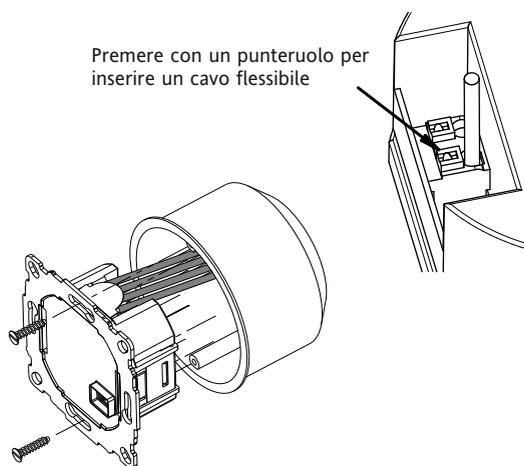
La linguetta di plastica deve essere posizionata in modo da isolare i morsetti/cavi dalle viti di fissaggio.
