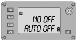
Attivazione / disattivazione dello spegnimento automatico dello strumento
