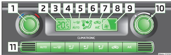
Fig. 83 Elementi di comando del Climatronic
