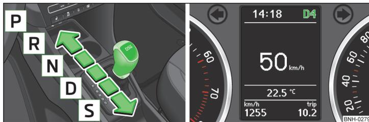
Fig. 91 Leva selettoria / visualizzazione su display
