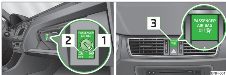
Fig. 12 Interruttore a chiave per disabilitazione dell'airbag frontale lato passeggero/spia di controllo per abilitazione/disabilitazione dell'airbag frontale lato passeggero
