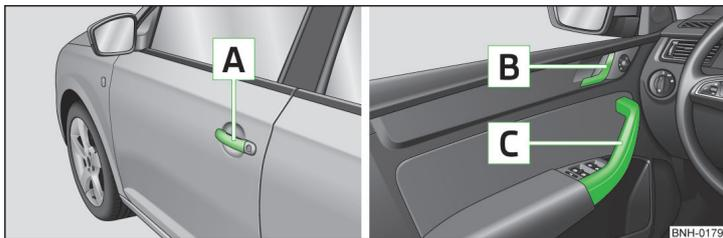
Fig. 32 Maniglia/leva per l'apertura della porta
