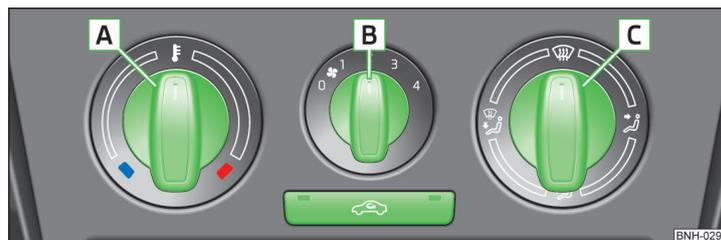
Fig. 81 Elementi di comando del riscaldamento
