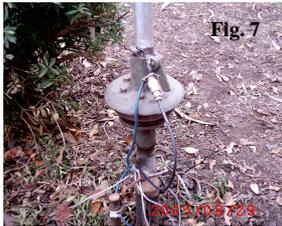
Per alimentare l'antenna utilizzo cavo RG-58. Questo, oltre ad essere poco costoso rispetto a cavi di categoria superiore, alle frequenze al di sotto dei 30 metri causa perdite trascurabili e sopporta potenze ben al di sopra del "full legal power".
