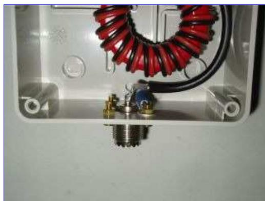
Foto 3 (Visione della parte inferiore dell'UNUN)
