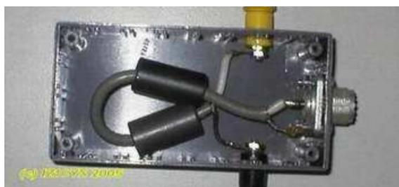
Poco male: un'induttanza di carico, per compensare la reattanza capacitiva tipica dell'antenna "corta", e siamo a posto. Naturalmente sarà bene, come la teoria delle antenne insegna, mettere l'induttanza non alla base, bensì ad almeno un terzo o metà altezza, dove la corrente è minore che alla base. Sempre seguendo la teoria, l'induttanza posta lungo il radiatore dovrà essere maggiore che non un'induttanza posta alla base.
