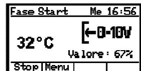
Le rispettive modalità vengono visualizzate sul display con i simboli 0/1 o 0-10V se un segnale è di competenza del comando esterno. Premendo il tasto di Stop è possibile interrompere in qualsiasi momento questa modalità. Compare la mano per il funzionamento manuale.
