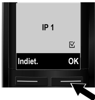
Nei seguenti display vengono visualizzate le connessioni IP configurabili (da IP 1 a IP 6). Le connessioni VoIP già configurate sono contrassegnate con .
