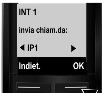
> Premere il tasto di navigazione **a destra**
