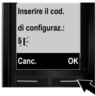
> Inserire il codice di autoconfigurazione tramite la tastiera (al max. 32 cifre).
