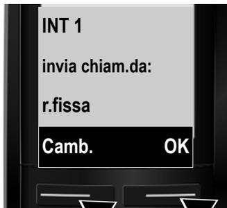
Viene visualizzata la connessione in uscita attualmente impostata per il portatile: **r.fissa**.
