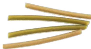
Questo tubino termo restringente di alta qualità ha una capacità di restringimento di 1/3. Di facile uso, si restringe anche in acqua bollente. Colorazioni: Marrone e verde traslucido disponibili in due pratiche misure da 2.4 a 0,8mm. e da 1.6 a 0,5mm.
