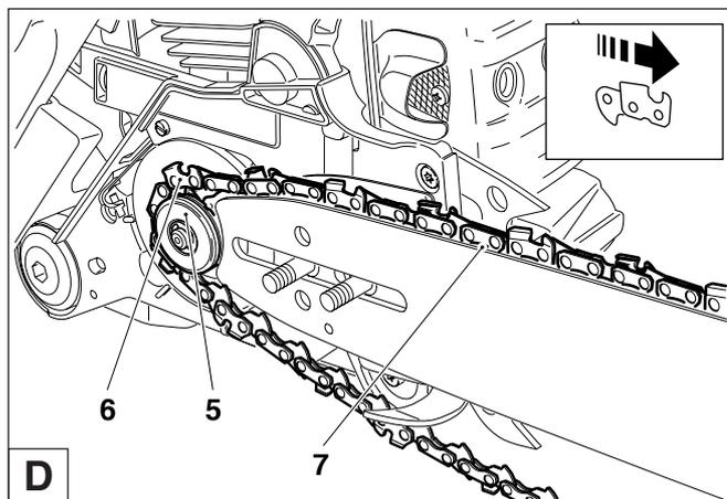
Poggiare la catena della sega (6) sulla ruota dentata (5). Con la mano destra inserire la catena della sega nella scanalatura di guida superiore della guida della sega (7).
