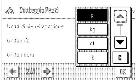
Nei menu di "Unità di visualizzazione" e "Unità Info" sono disponibili, oltre alle unità di pesata già conosciute, l'unità "PCS" (Pezzi), (premesse che sia già stato rilevato un peso del pezzo di riferimento).
