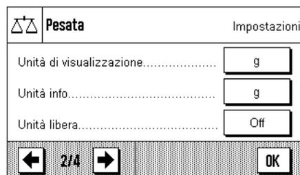
**"Unità di visualizz.":** Stabilisce l'unità per la visualizzazione del risultato (sezione 4.2.5).
