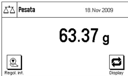
La bilancia è configurata, all'origine, in modo che il risultato della pesata sia visualizzato a grandi caratteri per una facile leggibilità. In questo modo di visualizzazione non sono visibili né i campi informazioni, né la guida grafica per i dosaggi "SmartTrac".
