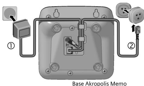
Collegare la spina telefonica in dotazione con il relativo cavo (solo se la vostra presa a muro è di tipo tripolare) quindi collegare sia il cavo di alimentazione di corrente ① che quello della linea telefonica ② prima nelle apposite prese della base poi nelle prese a muro, come indicato in figura. Inserire poi i cavi nelle apposite scanalature onde evitare che si strappino.
