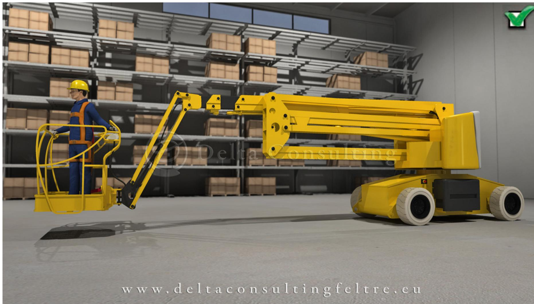
*Per lo spostamento della piattaforma aerea semovente occorre posizionare il piano di lavoro ad un'altezza da terra superiore ai 50 cm.*
