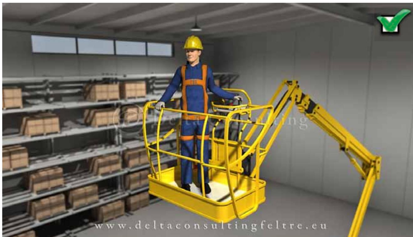
*Durante l'uso della piattaforma il lavoratore deve indossare il casco, le scarpe di sicurezza, i guanti e l'imbragatura di sicurezza.*
