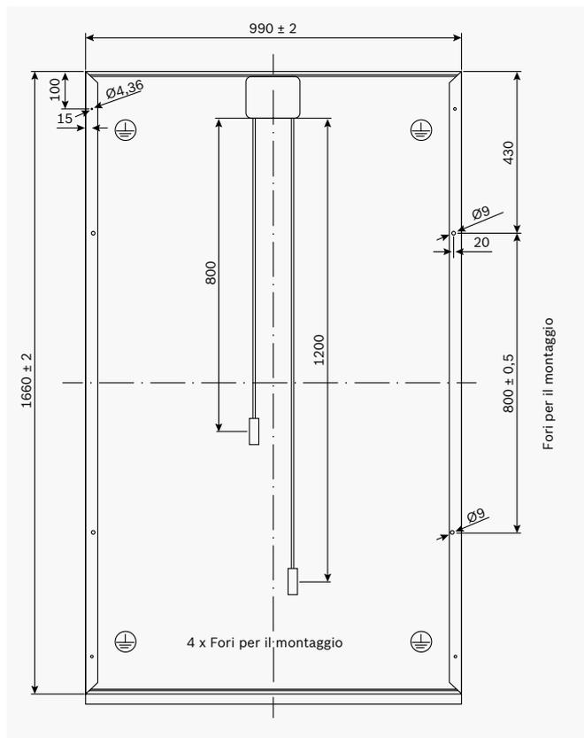
Figura 1: Parte posteriore c-Si M 60, P 60 e M 60 S, produttore 14, 17 e 23
