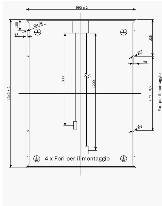
Figura 2: Parte posteriore c-Si M 48, c-Si M 48 S, produttore 23
