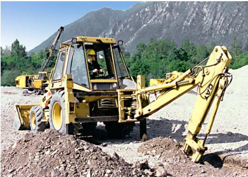
Anche nel caso delle terne, è possibile avere macchine di dimensioni contenute, tali da permettere di eseguire lavori in ambienti con spazi ristretti
