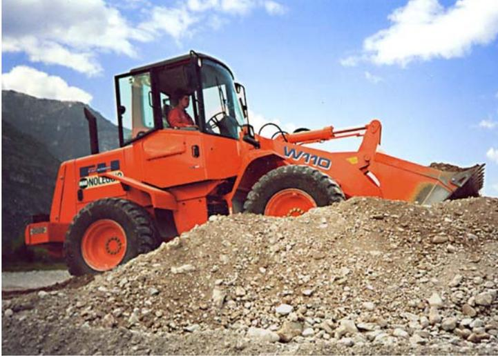
Le pale sono macchine in grado di eseguire uno scavo mediante un lungo braccio munito di un utensile, chiamato benna, dotato di denti anteriori di acciaio. Si differenziano dagli escavatori dalla forma della benna e le modalità operative: l'azione di asportazione del terreno avviene infatti con il movimento della macchina dal punto di scavo a quello di deposito del materiale. In tal modo sono indicate in situazioni dove è difficoltoso accedere con gli automezzi.
