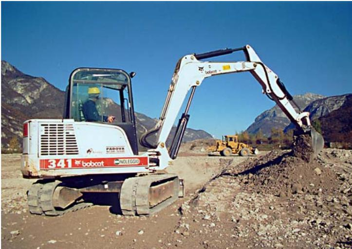
Esistono escavatori che permettono di eseguire lavori di escavazione con modesti spostamenti di terra in questo caso vengono denominati **miniescavatori**; tali mezzi sono di dimensioni ridotte e peso contenuto, in genere sono dotati di una benna rovescia e di una lama anteriore.
