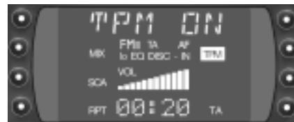
Quando TPM appare sul display con scritta inversa, significa che è in corso una riproduzione TPM. Vengono riprodotti tutti i brani di MiniDisc o di CD memorizzati con TPM. Se oltre a TPM viene attivato anche SCA
