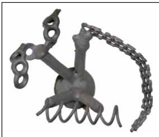
Fusione in cromo cobalto eseguita con Ephestos
