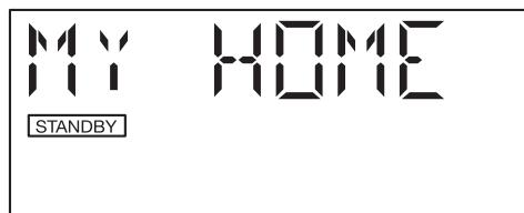
De Tuner heeft een verlichte display. De tuner wordt ingeschakeld door op een willekeurige toets te drukken. Als er in de laatste minuut niet op een toets gedrukt is, dan doven de verlichting van de display en de leds. De versterkers in de vertrekken worden niet automatisch ingeschakeld als de tuner met de bedieningstoetsen van het frontpaneel wordt ingeschakeld.
