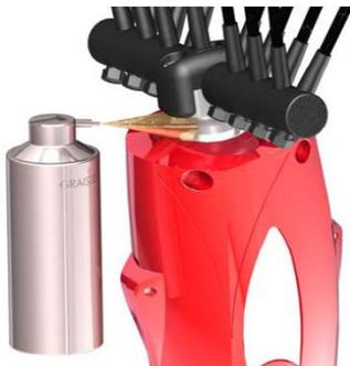
Per effettuare l'ingrassaggio posizionare l'ugello del vaporizzatore rivolto verso il giunto a sfera. Tenere la bomboletta perfettamente verticale e poi spruzzare. Ingrassare tutta la testa di vibrazione almeno una volta al giorno (senza smontare niente).
