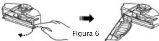
5. Sostituire con un nuovo filtro. Con una mano premere la staffa semicircolare per rilasciare la chiusura del filtro e rimuovere la griglia per inserire un nuovo filtro. (Vedi Figura 7)
