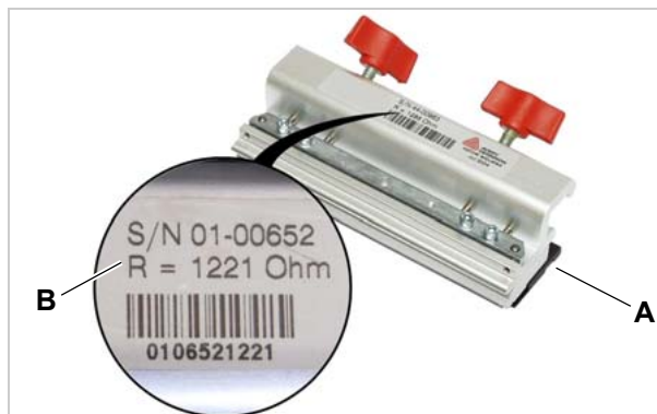
[96] Testina di stampa (A) con indicazione della resistenza (B), in questo caso: 1221 Ohm.
