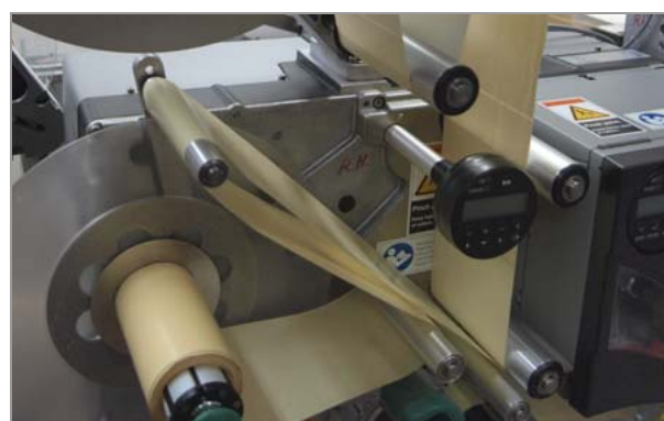
[56] Inserire la carta di supporto su braccio semovibile e rulli di rinvio.
