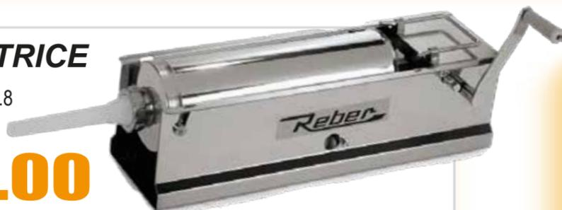
Dotate di ingranaggi in metallo di riduzione e moltiplicazione della velocità del pistone per agevolare e velocizzare le operazioni di insaccatura (lenta) ed estrazione del pistone a fine lavoro (veloce).
