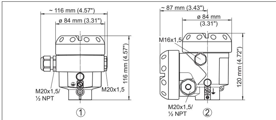
Figura 60: Le differenti custodie con grado di protezione IP 66/IP 68 (0,2 bar) - con tastierino di taratura con display incorporato l'altezza della custodia aumenta di 9 mm/0.35 in
