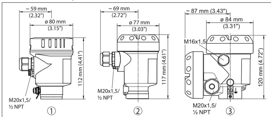
Figura 62: Le differenti custodie con grado di protezione IP 66/IP 68 (0,2 bar) - con tastierino di taratura con display incorporato l'altezza della custodia aumenta di 9 mm/0.35 in
