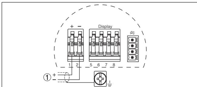
Figura 36: Schema elettrico custodia a una camera
