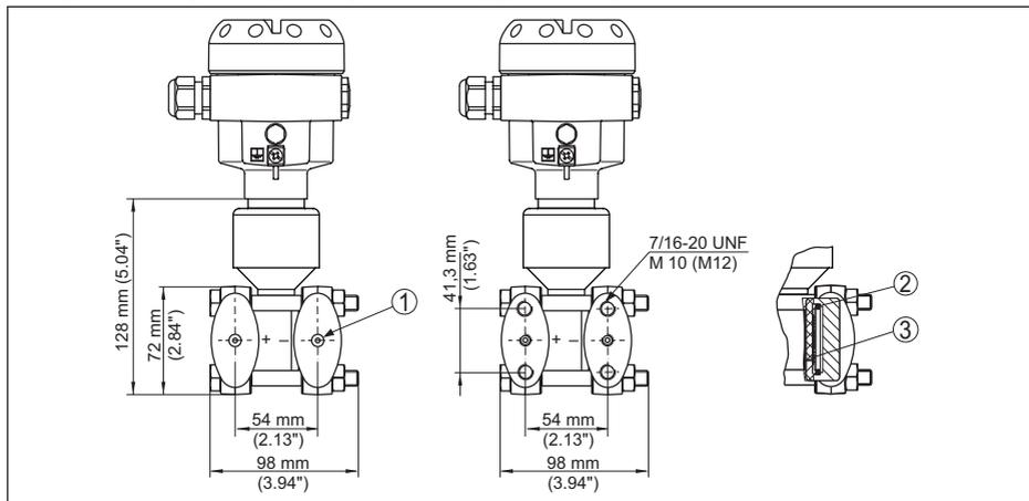
Figura 65: A sinistra: attacco di processo DPT-10 predisposto per montaggio su separatore. A destra: posizione della guarnizione ad anello di rame
