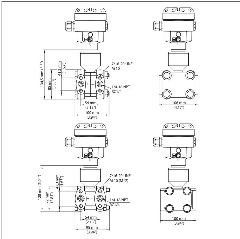
Figura 63: In alto: cella di misura da 10 mbar e 30 mbar. In basso: cella di misura da  $\geq 100$  mbar
