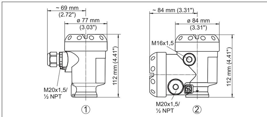
Figura 59: Le differenti custodie con grado di protezione IP 66/IP 68 (0,2 bar) - con tastierino di taratura con display incorporato l'altezza della custodia aumenta di 9 mm/0.35 in
