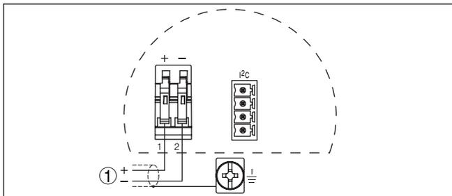
Figura 39: Schema di allacciamento custodia a due camere
