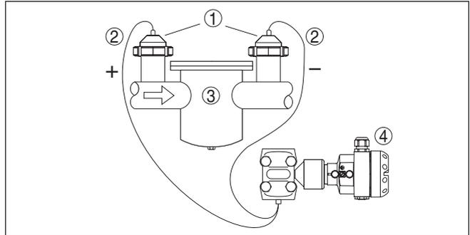
*Figura 32: Configurazione di misura per la misura di pressione differenziale su gas, vapori e liquidi*
