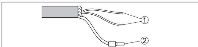
Figura 45: Assegnazione dei conduttori del cavo di collegamento
