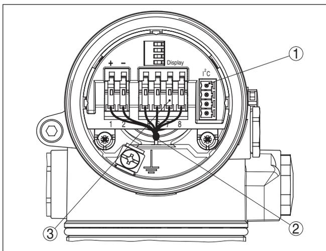
Figura 41: Vano dell'elettronica con custodia a due camere
