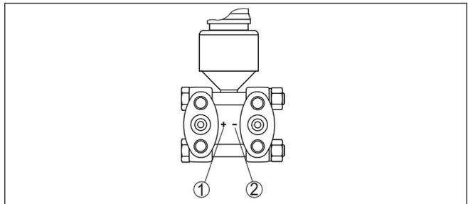
Figura 11: Contrassegno per il lato positivo/negativo sull'unità di processo
