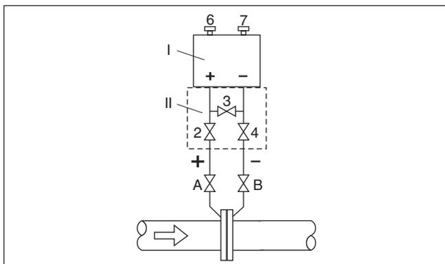
Figura 48: Configurazione di misura favorita per la misura su gas
