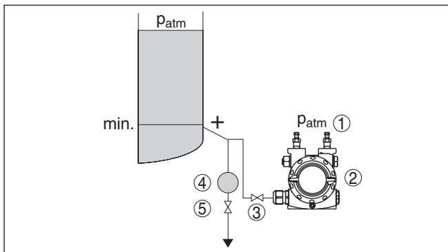
Figura 20: Configurazione di misura per la misura di livello in un serbatoio aperto
