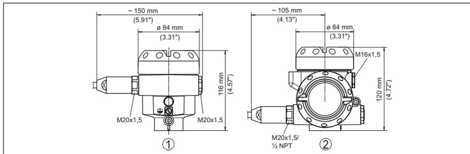
Figura 61: Le differenti custodie con grado di protezione IP 66/IP 68 (1 bar) - con tastierino di taratura con display incorporato l'altezza della custodia aumenta di 9 mm/0.35 in
