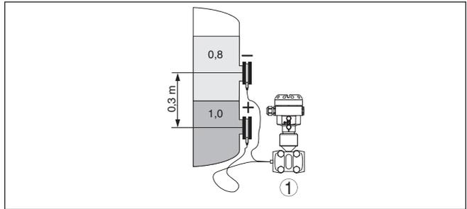
Figura 28: Configurazione di misura per la misura d'interfaccia
