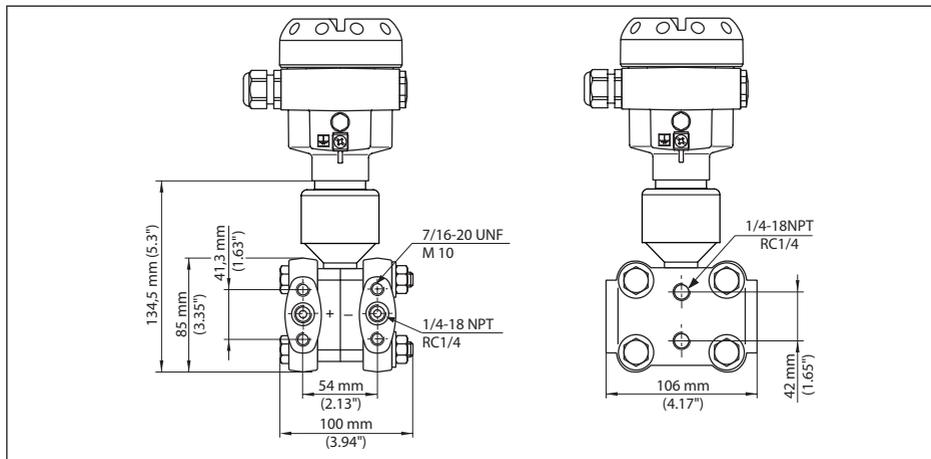
Figura 64: Cella di misura da 10 mbar e 30 mbar.
