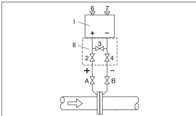
Figura 54: Configurazione di misura favorita per la misura su gas
