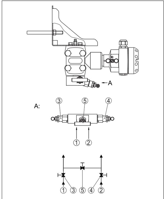
Figura 13: Allacciamento di un blocco a tre valvole
