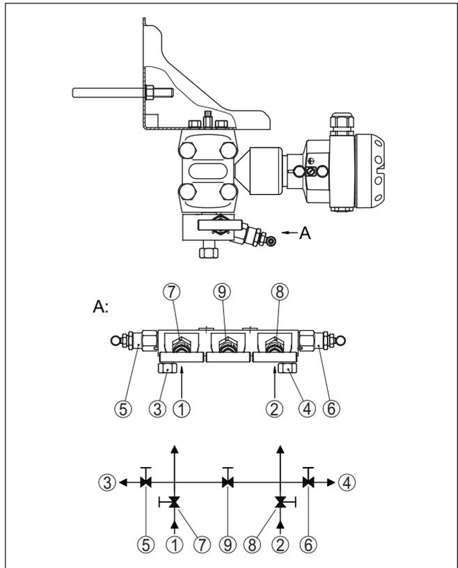
Figura 15: Allacciamento di un blocco di 5 valvole
