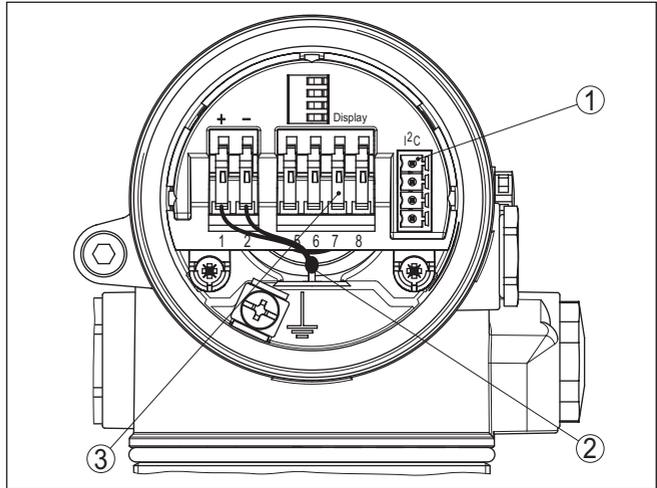
Figura 37: Vano dell'elettronica con custodia a due camere
