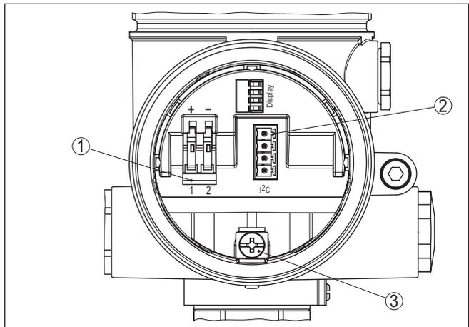
Figura 38: Vano di allacciamento custodia a due camere
