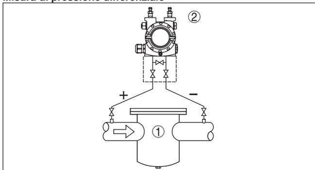
Figura 5: Misura di pressione differenziale con DPT-10
