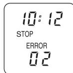
Quando la tensione della batteria nel vano 2 raggiunge un determinato valore soglia, scatta l'Allarme «ERROR 02: Batteria motore scarica (2)» e il microinfusore H-TRONplus emette un suono continuo. Il microinfusore H-TRONplus verifica la tensione della batteria motore ogni ora, ad ogni erogazione di insulina e ogni volta in cui il microinfusore H-TRONplus passa dalla modalità **STOP** alla modalità **RUN**.
