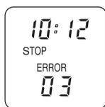
Quando la tensione della batteria nel vano 3 raggiunge un determinato valore soglia, scatta l'Allarme «ERROR 03: Batteria elettronica scarica (3)» e il microinfusore H-TRONplus emette un suono continuo. Il microinfusore H-TRONplus verifica la tensione della batteria motore ogni ora, ad ogni erogazione di insulina e ogni volta in cui il microinfusore H-TRONplus passa dalla modalità **STOP** alla modalità **RUN**.
