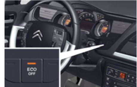
È possibile in qualsiasi momento disattivare il sistema premendo il comando "ECO OFF" ; la spia sul tasto si accende.
