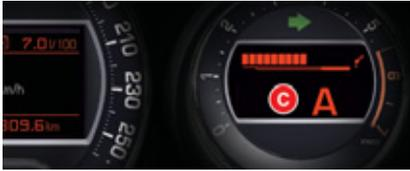
La posizione della leva di selezione e la modalità di guida appaiono sul quadrante **C** del quadro strumenti.
