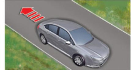
**In discesa, a veicolo fermo e con la retromarcia inserita, il veicolo rimane immobilizzato per un breve istante al rilascio del pedale del freno.**
