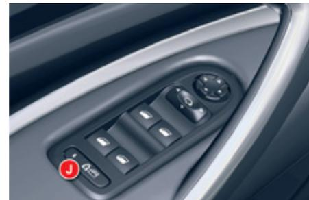
Permette di disattivare i comandi posteriori degli alzacristalli e l'apertura delle porte posteriori dall'interno. La sicurezza elettrica è attivata da un impulso sul comando J.
