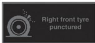
Il sistema di segnalazione pneumatici sgonfi è un supporto alla guida che informa sullo stato dei pneumatici.
