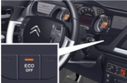
In caso di malfunzionamento del sistema, la spia sul comando **"ECO OFF"** lampeggia, poi si accende fissa.
