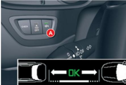
È possibile selezionare la funzione "Misura dello spazio disponibile" premendo il comando **A**, con l'indicatore di direzione attivato dal lato dello spazio da misurare, velocità inferiore a 20 km/h e distanza inferiore a circa 1,5 dallo spazio scelto per il parcheggio.
