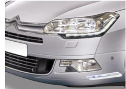
Per non disturbare gli altri automobilisti, questo sistema corregge automaticamente e a veicolo fermo, l'altezza del fascio delle lampade allo xeno, in funzione del carico del veicolo.
