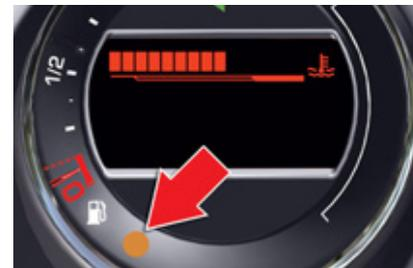
Su suolo orizzontale, l'accensione della spia livello minimo del carburante avverte che il serbatoio è in riserva.
