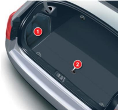
1. Alloggiamento della batteria per i veicoli equipaggiati di motore V6 HDi.
