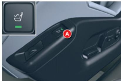
Questa funzione assicura un massaggio lombare sul sedile del guidatore, e funziona solo a motore avviato.
