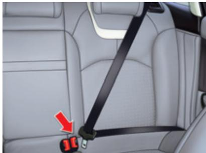
I sedili posteriori sono equipaggiati di tre cinture, ciascuna delle quali è dotata di tre punti di ancoraggio e di un avvolgitore con pretensionatore.
