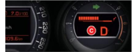
La posizione della leva di selezione e la modalità di guida vengono visualizzate nel quadrante **C** del quadro strumenti.
