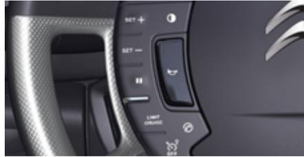
Questo sistema permette di mantenere costante la velocità del veicolo programmata dal guidatore.
