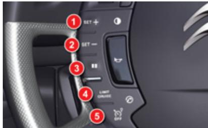
I comandi del limitatore di velocità sono situati sul lato sinistro del volante.
