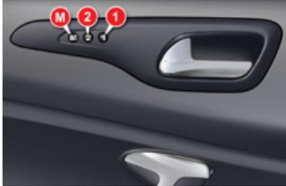
Sistema che tiene conto delle regolazioni del sedile del guidatore. Consente di memorizzare fino a due posizioni con i tasti del sedile lato guida.
