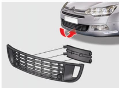
In caso di traino, è tassativo rimuovere il tappo otturatore sul paraurti anteriore e la guarnizione del cofano motore, se il veicolo ne è equipaggiato.
