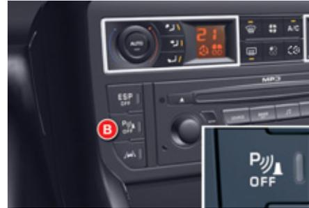
È possibile attivare/disattivare l'assistenza al parcheggio premendo il comando **B**. Se l'assistenza al parcheggio non è attiva, la spia del comando **B** è accesa.
