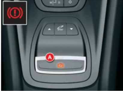
In caso di anomalia del sistema di frenata principale o in situazioni eccezionali (esempio: malore del guidatore, guida con accompagnatore...), tirare la levetta **A** e tenerla in questa posizione per fermare il veicolo.
