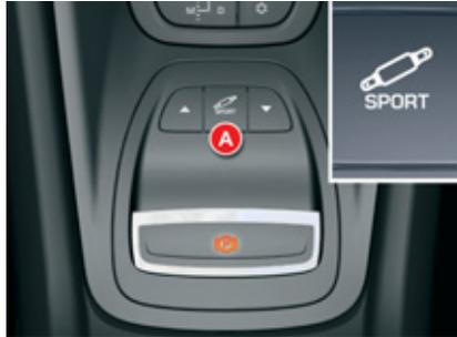
La sospensione si adatta automaticamente ed istantaneamente ai differenti stili di guida e al tipo di strada, conciliando al meglio il confort degli occupanti e la tenuta di strada del veicolo.
