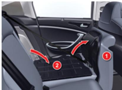
Panchetta ribaltabile separatamente a sinistra (2/3) o a destra (1/3) per modulare lo spazio di carico del bagagliaio.
