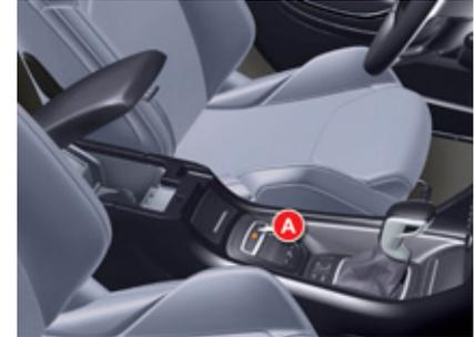
In caso di mancato disinserimento del freno di stazionamento elettrico, un comando d'emergenza permette di disinserirlo manualmente tenendo immobilizzato il veicolo per tutta la durata dell'azione.
