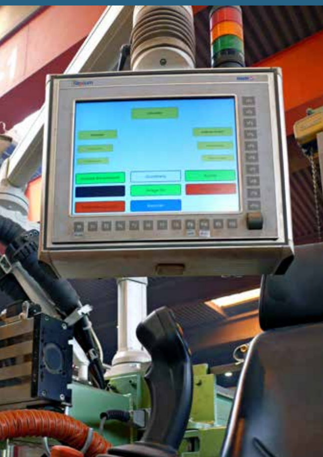
Sopra: schermo e joystick Sotto: operaio che imposta il sistema per il processo di saldatura utilizzando il joystick
