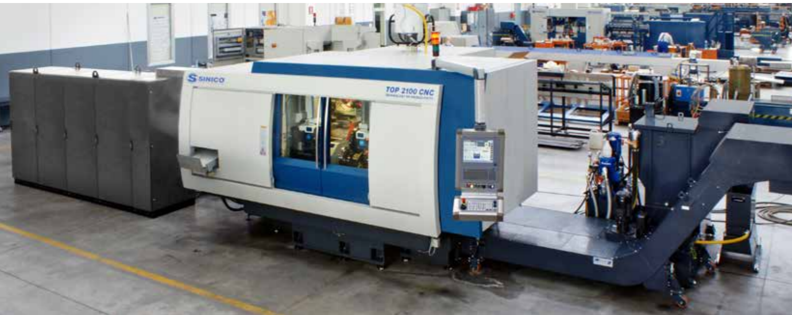
In basso: vista dell'intero complesso della macchina TOP 2100 CNC con l'unità di controllo CNC NUM Flexium
