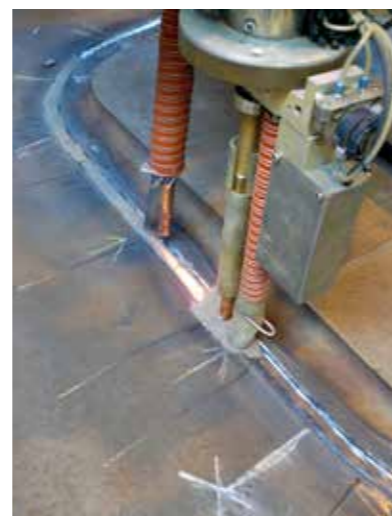
Sopra: sistema SA durante il processo di saldatura; il sistema si sposta sui punti di istruzione predefiniti Sotto: CNC NUM Flexium 68
