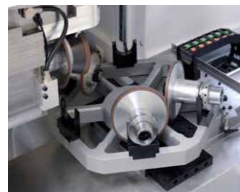
In alto: CAD rendering del centro di affilatura a cinque assi U-Grind In basso: cambia mole con sei porta mola
