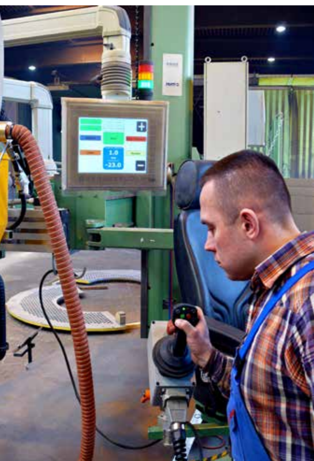
Sopra: schermo e joystick Sotto: operaio che imposta il sistema per il processo di saldatura utilizzando il joystick
