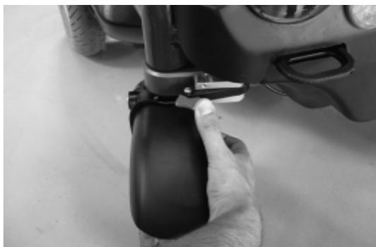
**Figura 19: rotazione della leva di sblocco**
