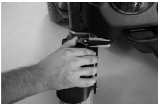
**Figura 18:** posizione standard delle leve di sblocco
