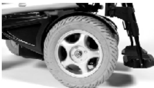
**Figura 44: vite della ruota**
