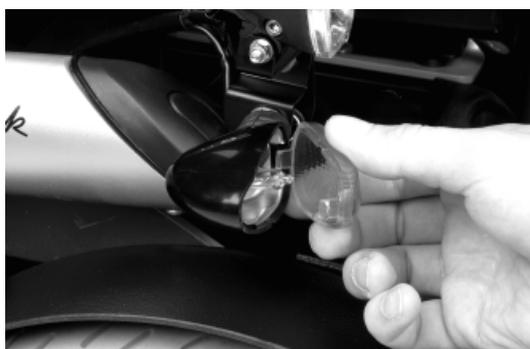
**Figura 40: rimozione del vetro del fanale**
