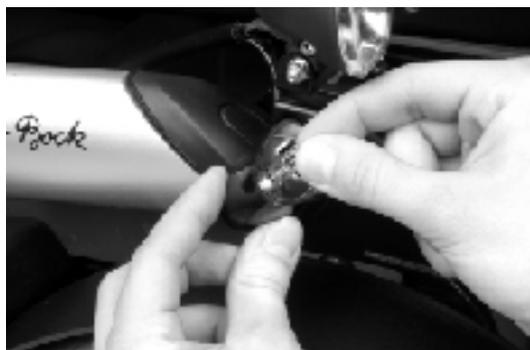
**Figura 41: rimozione della lampadina**
