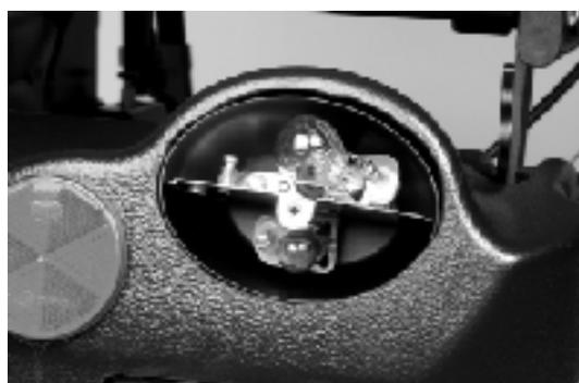
**Figura 42: sostituzione fanali posteriori**
