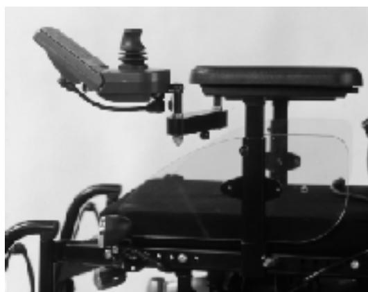
**Figura 31: joystick orientabile lateralmente**
