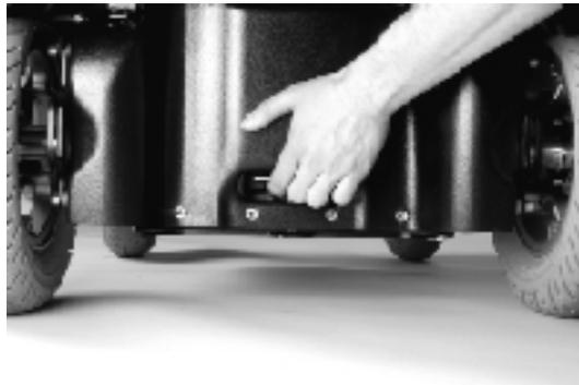
**Figura 24: apertura del cassetto portabatteria**
