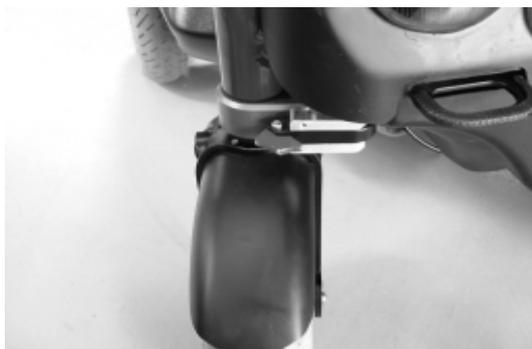
La carrozzina elettronica C1000, sbloccato il freno e le ruote posteriori, può essere spinta facilmente. Riparato il guasto, lo sblocco d'emergenza deve essere riportato alla sua posizione iniziale.
