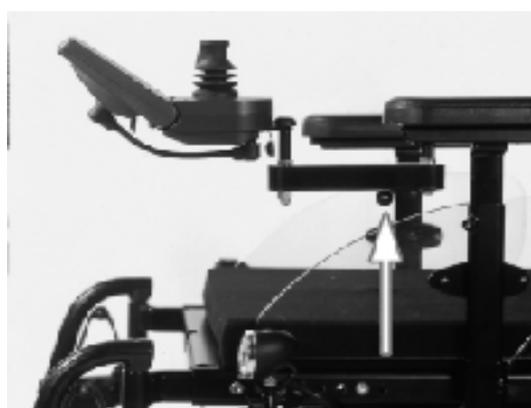
**Figura 30: leva di sblocco**
