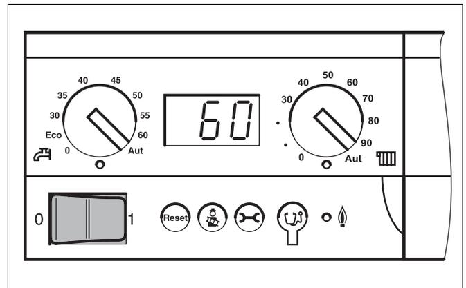
Fig. 6 Spegner l'impianto di riscaldamento
