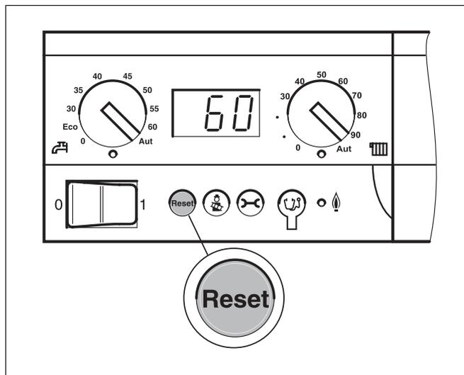
Fig. 9 Eliminazione dell'anomalia tramite il tasto "Reset"
