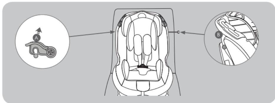
Ruotare verso l'alto il gancio di bloccaggio barra schienale (A) a lato seduta e sfilare dal lato opposto la barra di fissaggio (B) verso l'esterno.
