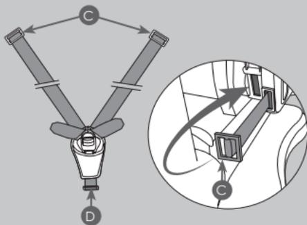
Inserire l'anello metallico della cintura inguinale, attraverso l'asola del cuscino, del rivestimento e attraverso al fessura sulla scocca (3). Assicurarsi del corretto inserimento e bloccaggio.
