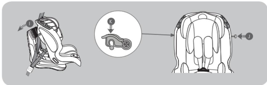
Riportare lo schienale della seduta in posizione originale (I). Facendo attenzione a non bloccare la cintura pettorale. Inserire completamente la barra di fissaggio (J) e bloccarla dal lato opposto ruotando verso il basso il gancio di bloccaggio barra schienale, fino ad udire lo scatto “click” che ne indica l’avenuto bloccaggio (K). Verificare tirando la barra che questa non si sfilì e che sia correttamente montata e bloccata.
