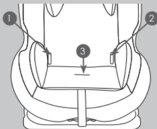
Inserire gli anelli metallici (C) della parte addominale della cintura nelle asole (1) e (2) del rivestimento e attraverso le fessure esterne sulla scocca. Inserire dalla parte posteriore della scocca, gli anelli metallici (C) attraverso le fessure interne.
