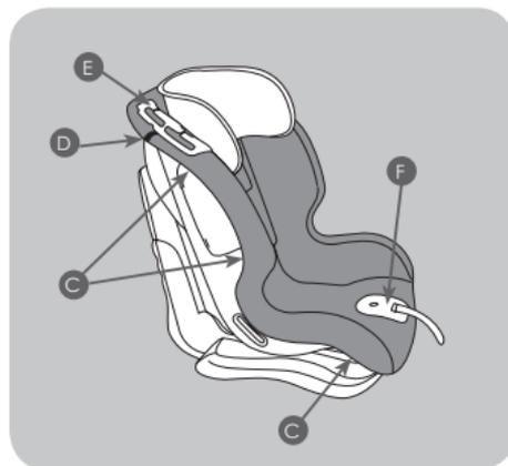
Il rivestimento è bloccato sulla scocca da una serie di ganci (C) posti nella parte posteriore e inferiore della scocca. Sganciare i ganci della copertura per rimuovere il rivestimento. Sganciare il velcro® (D).
