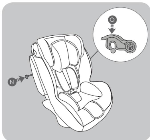
Riportare lo schienale della seduta in posizione originale. Inserire completamente la barra di fissaggio (N) e bloccarla dal lato opposto ruotando verso il basso il gancio di bloccaggio barra schienale, fino ad udire lo scatto “click” che ne indica l'avvenuto bloccaggio (O). Verificare tirando la barra che questa non si sfili e che sia correttamente montate e bloccata.
