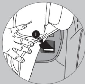
Verificare che nessuna cinghia sia attorcigliata, ricollegare tra loro le cinghie delle imbottiture delle protezioni pettorali tramite il gancio (J) e infilare le cinture delle bretelle sulla staffa metallica tendicintura (K).
