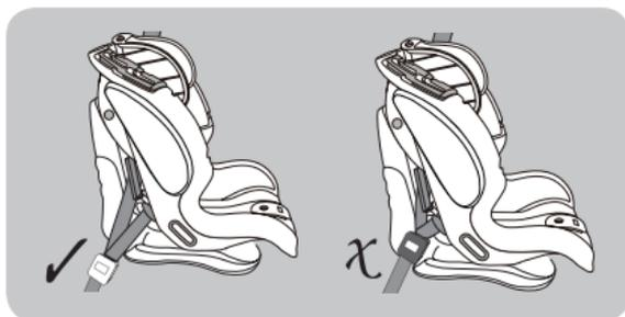
Dopo l’installazione, controllate che il seggiolino sia correttamente fissato sul sedile, provando a muoverlo lateralmente, l’oscillazione laterale deve essere minima. Se riscontrate un’ampia oscillazione ripetere il montaggio assicurandovi di tensionare correttamente la cintura prima del suo bloccaggio con la clip.
