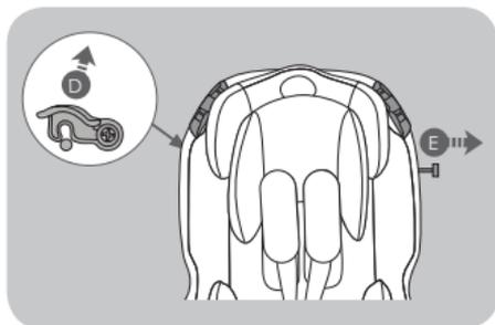
Ruotare verso l'alto il gancio di bloccaggio barra schienale (D) a lato seduta e sfilare dal lato opposto la barra di fissaggio (E) verso l'esterno.
