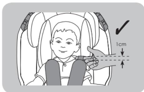
La regolazione ideale dell'imbracatura è tale da consentire l'inserimento di un dito (1cm) nella parte superiore sopra la spalla.
