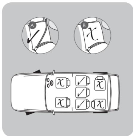
Il seggiolino può essere utilizzato solo con cinture di sicurezza a 3 punti (A) e NON con cinture di sicurezza a 2 punti (B).
