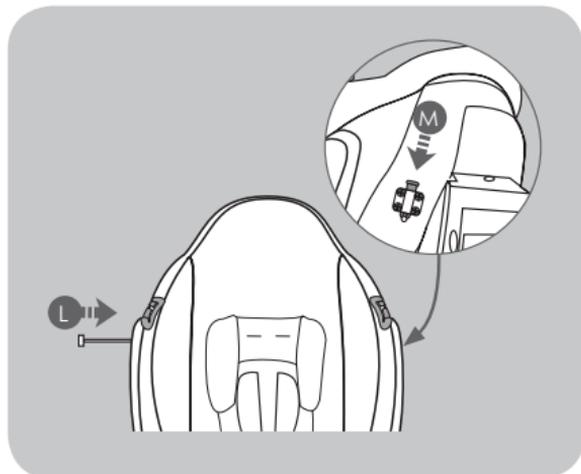
Riportare lo schienale della seduta in posizione originale. Inserire completamente la barra di fissaggio (L) e bloccarla dal lato opposto ruotando verso il basso il gancio (M) di bloccaggio barra schienale, fino ad udire lo scatto “click” che ne indica l’avvenuto bloccaggio. Verificare tirando la barra che questa non si sfili e che sia correttamente montate e bloccate.
