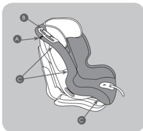
**Il rivestimento ha un impatto diretto sul funzionamento del dispositivo di ritenuta in termini di sicurezza. Non utilizzare mai il seggiolino auto privo del rivestimento.**
