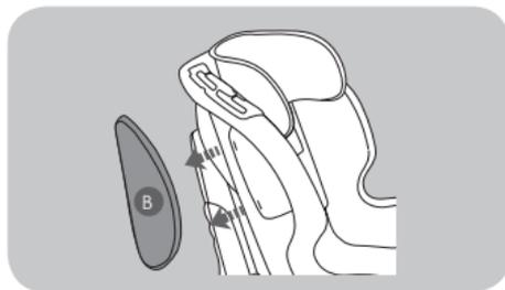
Rimuovere i cuscini di protezione laterale (B) tirando in direzione delle frecce, per sganciarli dalla scocca e rimuovere poi il rivestimento dalle protezioni.
