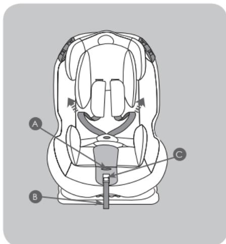
Quando il bambino crescendo, supera la configurazione di utilizzo del GRUPPO 1 (da 9 a 18kg), il seggiolino auto deve essere trasformato per l'utilizzo nel GRUPPO 2 (da 15 a 25 kg) o per il GRUPPO 3 (da 22 a 36 kg). In questa configurazione è necessario rimuovere la cintura a 5 punti (imbracatura) in dotazione al seggiolino auto.
